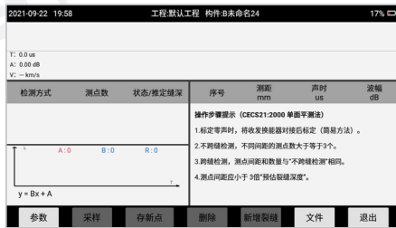
图 4.1 裂缝主测量界面
